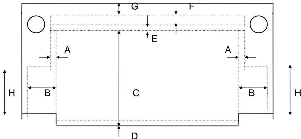
**Figure 2-4: Dégagements et marges des profils rectangulaires / Clearances and Allowances for Box Profiles**
